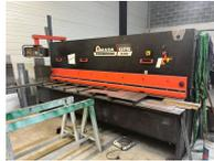
Cisaille AMADA - PROMECAM GPS 630 à commandes numériques en 3m de coupe jusqu'à 6mm de coupe acier environ 25 ans
