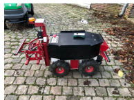
Robot de maraichage autonome guidé par GPS. Ce robot est quasiment neuf, 9 heures d'utilisation, et propose tous les accessoires disponibles. Longueur: 130cm, Largeur: 47cm, Hauteur: 83cm, Débit de Chantier 1.000m2 par heure, Poids 150Kg, 100% Electrique
