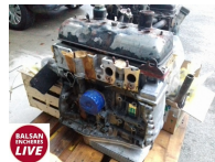
Moteur ALPINE 1600SX. Type moteur 84330 - Cylindrée 1647 cm3 - Bloc alu - Culasse alu - N° de moteur 50004341. Vendu sans réserve.
