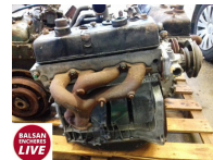
Moteur ALPINE 1600 S. Type moteur 807-12 - Cylindrée 1565 cm3 - Bloc alu - Culasse alu - N° de moteur : 0069. Vendu sans réserve.
